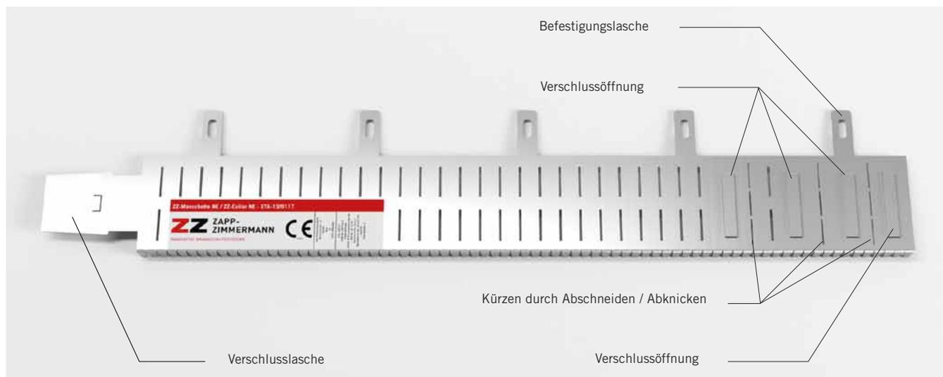
Aus der ZZ-Manschette NE 50 - 110 und ZZ-Manschette NE 125 - 160 können zusätzlich drei Größen durch Zuschneiden bzw. Abknicken hergestellt werden. Dazu sind im Manschettenblech Schlitz (3 Stück, s. Bild) vorhanden, die die Stelle zum Abschneiden / Abknicken markieren.
