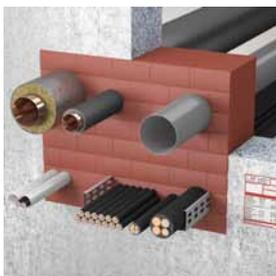
Beispiel für eine Abschottung mit Brandschutzsteinen (Wandabschottung (B x H) bis max. 1000 x 1000 [mm], bei Deckenabschottung Breite max. 700 mm, Länge unbegrenzt). Nachinstallationen sind hier einfach und staubfrei durchzuführen.
