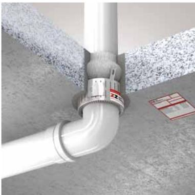
ZZ-Manschette NE in Massivdecke, Eingesetzte Montage, auf 90° Rohrwinkel, deckenunterseitig
