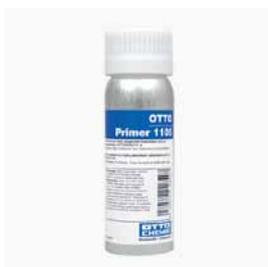
OTTO Primer 1105 wird zur Vorbehandlung von Fugenflanken für den Einsatz von ZZ-Brandschutzsilikon NE verwendet. Er verbessert die Haftung des Silikons auf mineralischen Werkstoffen (z. B. Beton, Putz, Porenbeton) und auf saugenden Untergründen (z. B. Gips, Faserzement).
