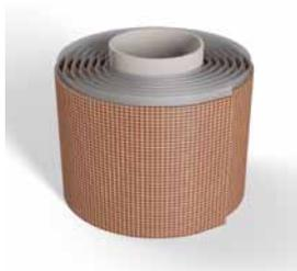
Der ZZ-Wickel NE ist ein volumenbeständiges, lösemittelfreies, selbstklebendes, plastisches, im Brandfall intumeszierendes Butyldichtungsband, das für die Feuerwiderstandsklasse EI 120 im Abschottungssystem ZZ-Brandschutzschaum 2K NE als Kabelwickel zur Anwendung kommt.
