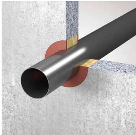
Muster-Leitungsanlagen-Richtlinie in Massivwand
