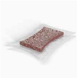
Verschließen Sie enge Restöffnungen mit dem ZZ-Vakuumstein. Nach Öffnen der Folie expandiert der ZZ-Vakuumstein auf die Standardgröße. Die Folie darf nach der Expansion im Schott verbleiben.
