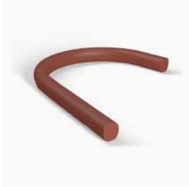
Das ZZ-Fugenband NE wird einfach mit dem vorgeschriebenen Übermaß von beiden Seiten in die Fuge eingeschoben. Durch seine elastische Struktur kann es Dehnbewegungen bis 25% ausgleichen. Für die Montage des ZZ-Fugenband NE ist keine Verklebung mit dem Bauteil erforderlich. Wahlweise kann als Abschluss zusätzlich ein Dichtstoff aufgebracht werden (z.B. Silikon OTTOSEAL S 115 oder Acryl OTTOSEAL A 207).
