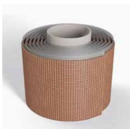
Der ZZ-Kabelwickel BDS-N ist ein volumenbeständiges, lösemittelfreies, selbstklebendes, plastisches, im Brandfall intumeszierendes Butyldichtungsband. Er wird als Systemkomponente für Kabel mit einem Durchmesser von mehr als 18 mm im System ZZ-Steine 120 BDS-N (Zul. Nr. Z-19.15-1743) sowie im System ZZ-Platte BDS-N (Zul. Nr. Z-19.15-1861) verwendet.
