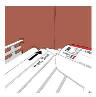
**ZZ®** 300 Brandschutzmasse zur beidseitigen Verfüllung von Kabelzwischenräume, Zwickel und offene Fugen müssen mindestens 30 mm tief verfüllt werden. Zwischen den einzelnen Brandschutzplatten bzw. zwischen den Brandschutzplatten und den durchgeführten Medien sind die Fugen mindestens 30 mm tief zu verfüllen.
