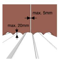
Die Öffnungen für die durchzuführenden Medien sind so auszuschneiden, dass zwischen der Platte und den durchgeführten Medien eine Fuge mit maximal 20 mm Breite entsteht und zwischen den Platten maximal 5 mm.
