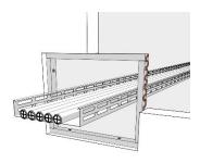
ZZ® 203 Brandschutzplatte müssen zur Befestigung anhand von Leisten aus nichtbrennbaren Bauplatten in der Bauteillaibung, mit geeigneten Schrauben in ausreichender Anzahl, zu befestigen und sind vorher mit ZZ® 300 Brandschutzmasse zu verkleben. In Wänden können die Leisten alternativ nur mit
