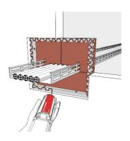
Beim Einbau in Massivwandstärken größer als 175 mm darf die **ZZ**<sup>®</sup> 203 Brandschutzplatte wahlweise nur durch Verklebung auf den Befestigungsleisten mit **ZZ**<sup>®</sup> 300 Brandschutzmasse befestigt werden. Hierbei ist zu beachten, dass sie mindestens einseitig zu verschrauben ist. Weitere Einbauschritte wie bei der aufgeschraubten Version.
