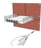
**ZZ®** 203 Brandschutzplatte beidseitig, anhand der Befestigungsschrauben, im Bauteil verschrauben.
