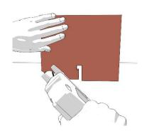
**ZZ**<sup>®</sup> **203 Brandschutzplatte** entsprechend der Belegung und der Schottgröße zuschneiden.
