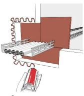
**ZZ®** 300 Brandschutzmasse zwischen den einzelnen Brandschutzplatten und dem Bauteil zum rauchgasdichten Verschluss aufbringen.
