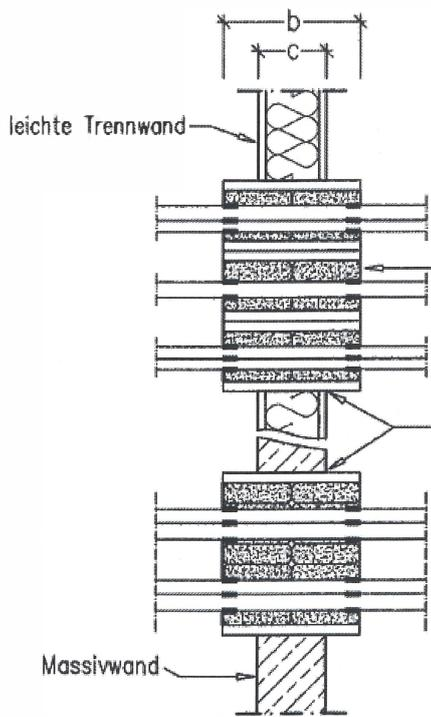
Fugen zwischen Wand und Bauteil mit mineralischen Mörtel, Gips oder "ZZ-Masse NE" bzw. ZZ-Brandschutzmasse BDS-N" gemäß Abschnitt 2.1.2  $\geq 2$  cm verschließen
