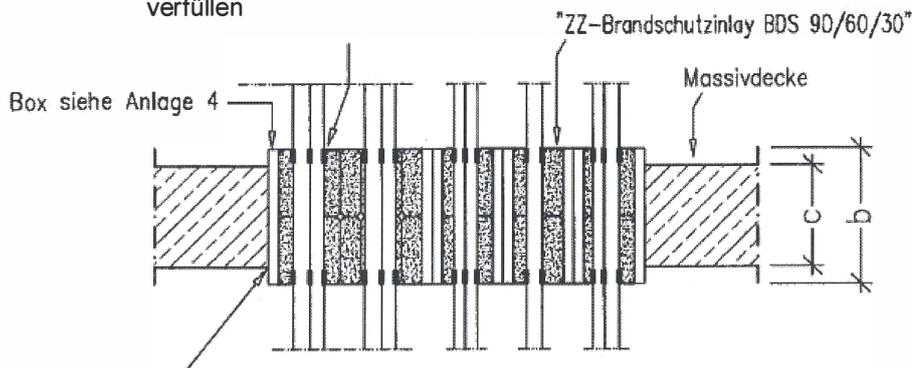
Fuge zwischen Decke und Box von Deckenunterseite her mit mineralischem Mörtel, Gips oder "ZZ-Masse NE" bzw. ZZ-Brandschutzmasse BDS-N" gemäß Abschnitt 2.1.2 ≥ 2 cm verfüllen
