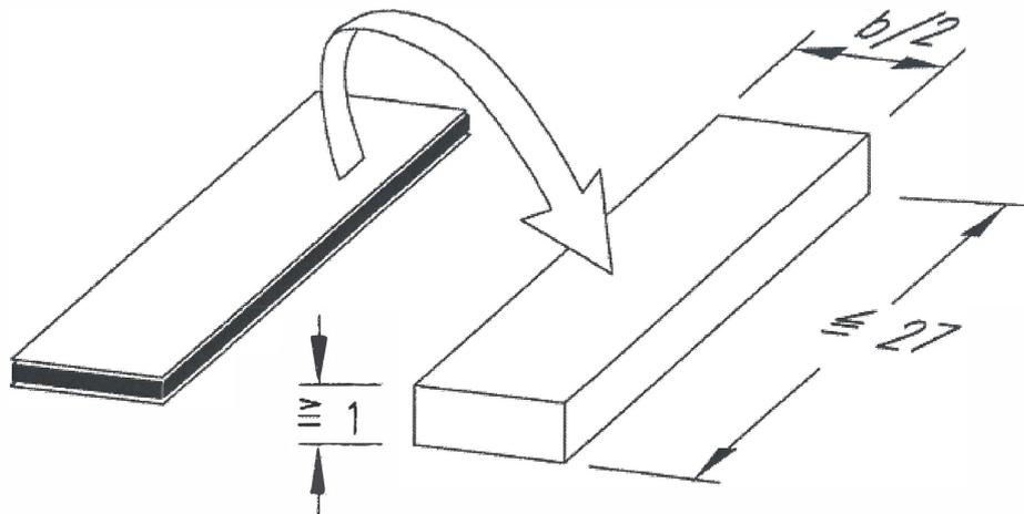
Der Vakuumstein wird in die Restspalte eingefügt und verschließt diese nach Öffnen der Folie.
