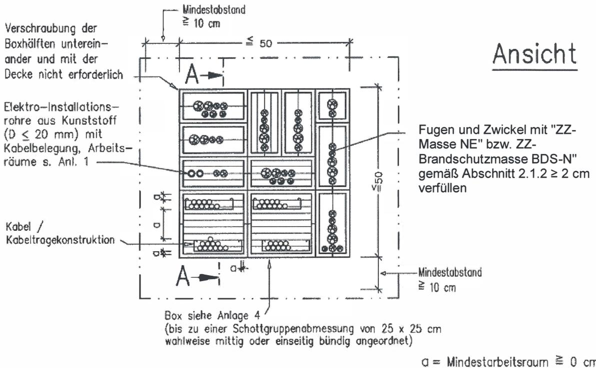
Fugen und Zwickel mit "ZZ-Masse NE" bzw. ZZ-Brandschutzmasse BDS-N" gemäß Abschnitt 2.1.2 ≥ 2 cm verfüllen
