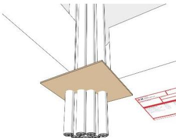
Bei größeren Öffnungen in Decken ist die Verwendung einer deckenunterseitigen Schalung zu empfehlen. Um die richtige Verfülltiefe zu erreichen, können eingedrückte Schalungen verwendet werden. Diese können auf/in der Abschottung verbleiben.
