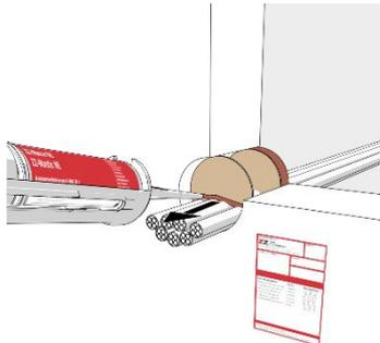
**ZZ**<sup>®</sup> 333 Brandschutzmasse gleichmäßig von hinten nach vorne in die Öffnung einbringen. Zwickel sind mit ausreichend Dichtstoff zu verfüllen.
