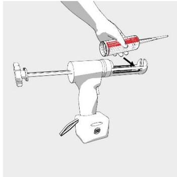
Kartusche in das vorgesehene Auspressgerät einlegen.
