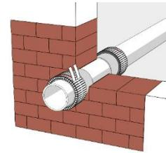
**ZZ® 400 Brandschutzmanschette** um das zu schützende Rohr anlegen und die Befestigungslaschen durch die Aussparungen im Manschettenblech ziehen. Danach soll die Manschette dicht an das Schott geschoben werden und die Befestigungslaschen, zur Fixierung, um 180° umgebogen werden.
