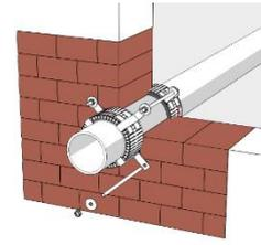
**ZZ® 400 Brandschutzmanschette** bei einer Wandmontage beidseitig anbringen. Hierbei können dieselben Gewindestangen für beide Manschetten verwendet werden.
