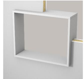
Gegebenenfalls müssen Aufleistungen vorgesehen werden. Für leichten Trennwänden ist eine brandschutztechnisch wirksame Laibung erforderlich. Die genauen Anforderungen sind den entsprechenden Nachweisen zu entnehmen.
