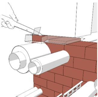
**ZZ**<sup>®</sup> 220 Brandschutzstein vakuumiert zum Verschließen von Restöffnungen. Hierfür den verpackten Stein in die Öffnung legen und danach die Folie aufschneiden. Die Folie kann in der Abschottung verbleiben, jedoch muss sie beidseitig bündig zum Schott entfernt werden.
