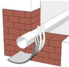
Aus Schallschutzgründen sollte die PE-Schallschutzisolierung unter der Manschette, und optional durch die Abschottung, eingesetzt werden. Die Isolierung kann anhand des beigelegten Klebestreifens um die Installation befestigt werden.
