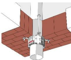
**ZZ® 400 Brandschutzmanschette** muss bei einer Deckenmontage unterseitig angebracht werden.
