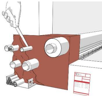
Überstehenden **ZZ® 330 Brandschutzschaum** unter Beachtung der notwendigen Schutzmaßnahmen und Sicherheitsbestimmungen nach circa 2 Minuten mit einem geeigneten Messer abschneiden.
