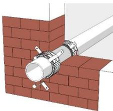
Die erforderliche Anzahl an Befestigungswinkel an der Manschette montieren. Dabei ist zu beachten, dass einer der Winkel über den Befestigungslaschen angebracht wird.
