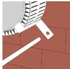
**ZZ® 400 Brandschutzmanschette** anhand von Gewindestangen  $\varnothing 6$  mm durch das Schott führen und mit Unterlegscheiben und Muttern befestigen.
