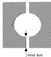
Alternativ zur Manschette kann für die Deckenmontage von bestimmten Rohren (siehe Nachweise) auch ein Streckmetallgitter verwendet werden.
