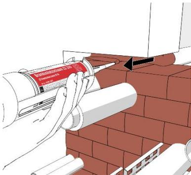
**ZZ® 330 Brandschutzschaum** zur Verfüllung von schmalen Öffnungen zwischen **ZZ® 220 Brandschutzstein** und der Bauteilfuge. Die zu verfüllende Fläche darf maximal 450 mm x 500 mm betragen und soll über die gesamte Schottdicke erfolgen.
