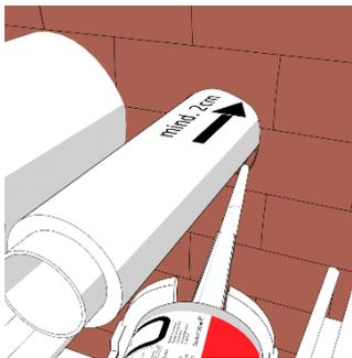
**ZZ**<sup>®</sup> 300 oder **ZZ**<sup>®</sup> 333 Brandschutzmasse zur beidseitigen Verfüllung von Kabelzwischenräume, Zwickel und offene Fugen um mindestens 20 mm. Für die Verwendung von Kartuschen siehe den Abschnitt „MONTAGESCHRITTE **ZZ**<sup>®</sup> 330 Brandschutzschaum“. Bei der Verwendung von **ZZ**<sup>®</sup> 300 oder **ZZ**<sup>®</sup> 333 ist es nicht erforderlich den Vorlauf zu verwerfen.
