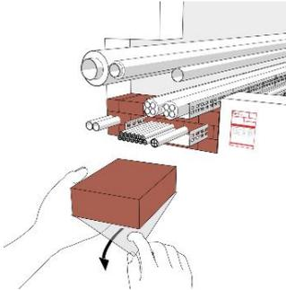
**ZZ**<sup>®</sup> 220 Brandschutzstein strammsitzend im Mauerverband in der Bauteilöffnung, nach Abzug der Schutzfolie, einbauen.
