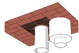
Das Streckmetallgitter wird, wie die Manschette, anhand von Durchsteckmontage am Schott befestigt.
