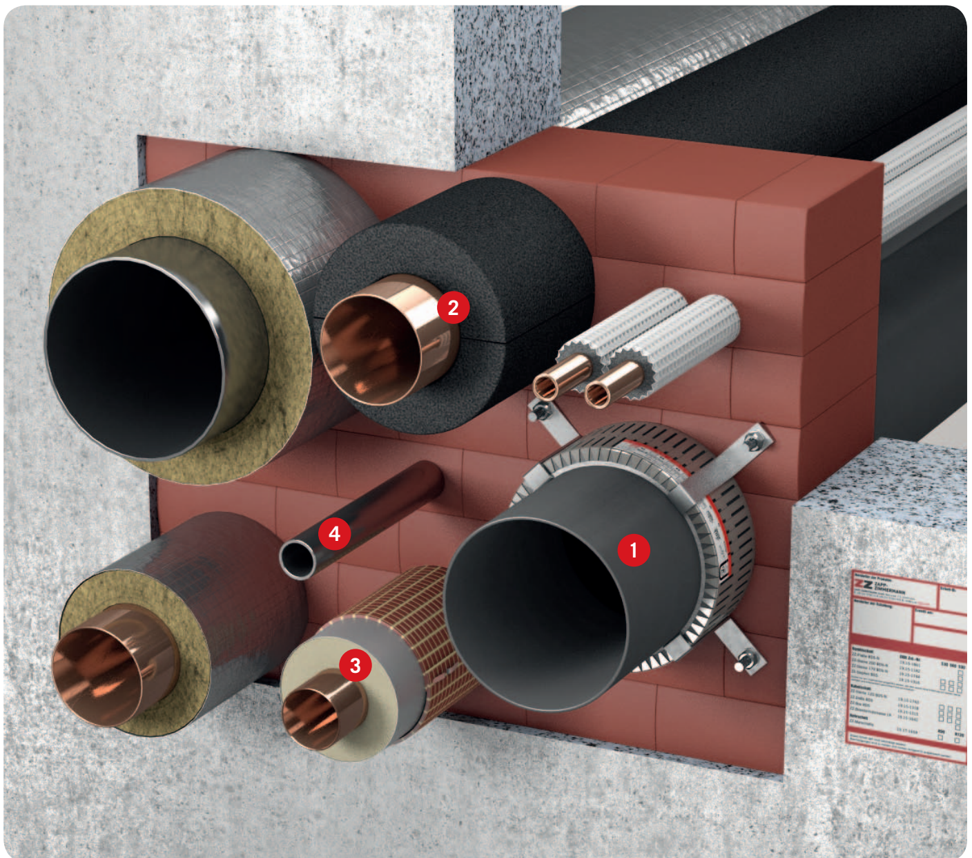
Kombischott ZZ-Steine 170 BDS-N – Längseinbau mit 170 mm Schottstärke
