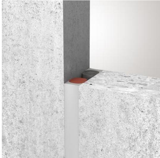
Bei einem Einbau der Brandschutzfugendichtung „ZZ 530“ sowie der beidseitigen Abdichtung mit Silikon ist das Aufnahmevermögen der Bewegungen zwischen getrennten Bauteilen besonders hoch (25 % lateral, 7,5 % Scherung). Mit dieser Ausführung ist unter Verwendung eines geeigneten Silikondichtstoffes auch die Erstellung einer feuerwiderstandsfähigen Hochbaufuge nach DIN 18540 bzw. DIN EN ISO 11600 möglich.
