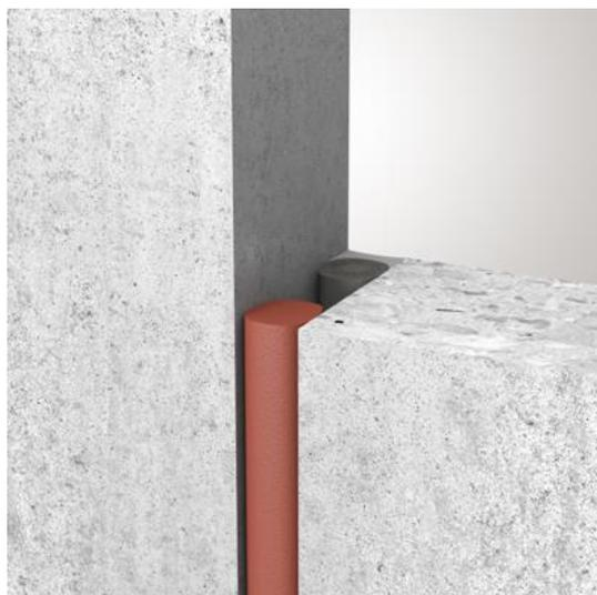
Ebenfalls neu in der Anwendung geprüft: Die Abdichtung einer Fuge mit einer Kombination der einseitig eingebrachten Brandschutzfugendichtung „ZZ 530“ und einer auf der gegenüberliegenden Bauteilseite eingebrachten Abdichtung aus Silikon für eine Feuerwiderstandsklassifizierung bis EI 120.
