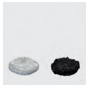
Intumeszenzwirkung Baustoff ZZ® 345 Brandschutzsilikon
