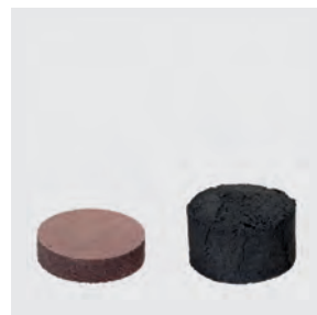
Intumeszenzwirkung Baustoff ZZ® 10-A Brandschutzschaum
