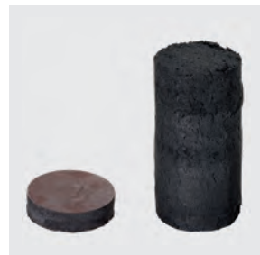
Intumeszenzwirkung Baustoff ZZ® 10-F Brandschutzschaum
